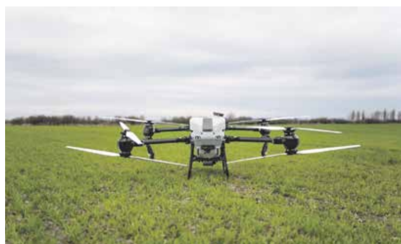
Aplikace postřiků dronem je velmi efektivní, stroj využívá leteckých dat a vědeckých poznatků, jejichž propojením vznikly speciální mapy. Ty zobrazují místa, kde se nachází komáří líhniště, a právě tam na ně dron zaútočí.
