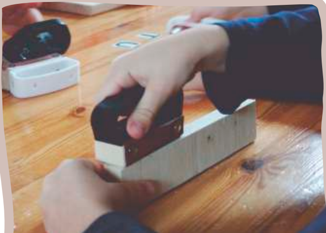
Pro broušení s nejmenšími dětmi můžeme k dřevěnému hranolku s brusným papírem přišroubovat i rukojeť ze starého kartáčku.
