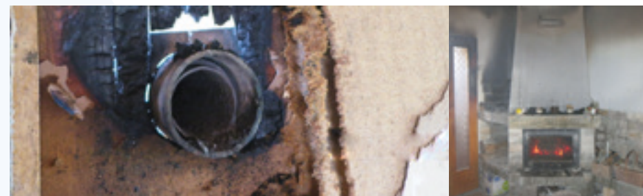
Důsledek špatné instalace topidel a kouřovodů
