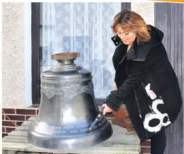
Zvonařka Leticie Vránová - Dytrychová provádí zkoušku akustického obrazce zvonu speciální ladičkou. Foto: Jan Teimer
